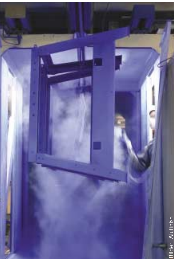
Komponenten von Holzbearbeitungsmaschinen während der Pulverbeschichtung
