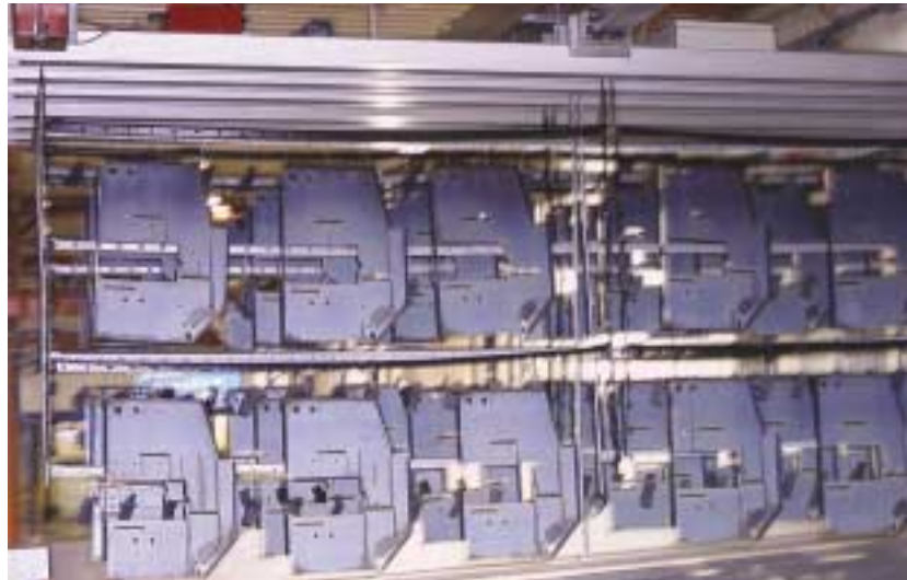
Eisenphosphatierte Stahlbleche auf dem Weg zum Haftwassertrockner
