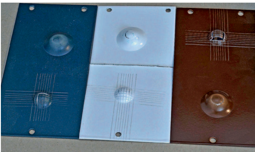
Mechanische Oberflächenprüfung an Testblechen
