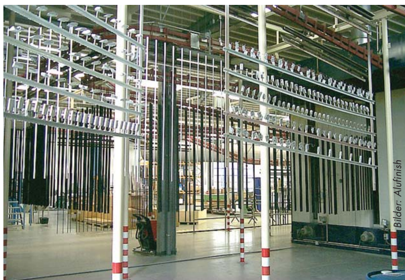
Fertig für die Pulverbeschichtung: Vorbehandelte Profile und Kleinteile für Duschkabinen
