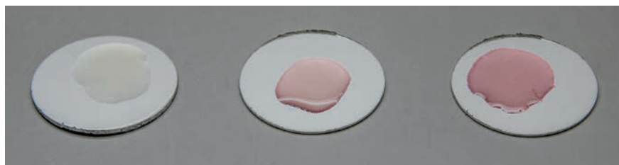
Farbtropfentest zur schnellen Beurteilung der voranodisierten Oberfläche. Links: keine Schicht vorhanden, nur voranodisiert; Mitte: normale Titanschicht; rechts: hohe Schichtauflage.
