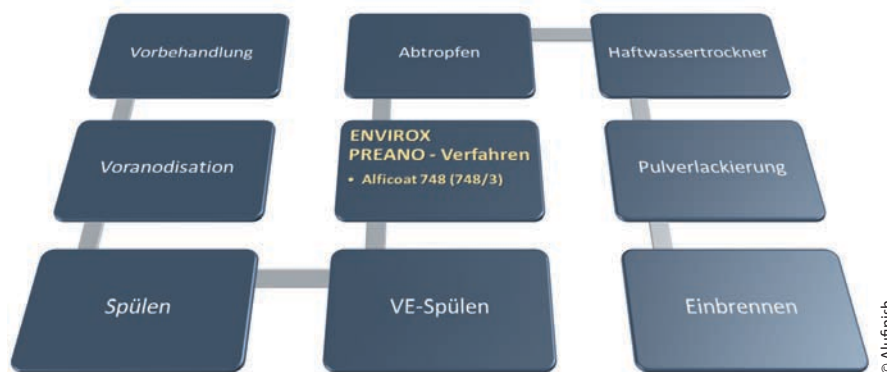
Vereinfachter Verfahrensablauf zur Anwendung der neuen Vorbehandlungs-Methode (VE = vollentsalztes Wasser).
